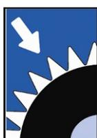
**Olovo, mikroorganismy** jsou zadrženy na povrchu filtru s antibakteriální úpravou. Jemná porézní struktura filtru 0,5  $\mu$  resp. polypropylenová membrána 0,2  $\mu$  nedovolí jejich proniknutí a vyplavení z filtru zpět do vody.
